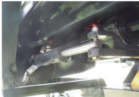
Zafes individuales por cuerpo. Evitan roturas de cajas al momento de un atascamiento.
