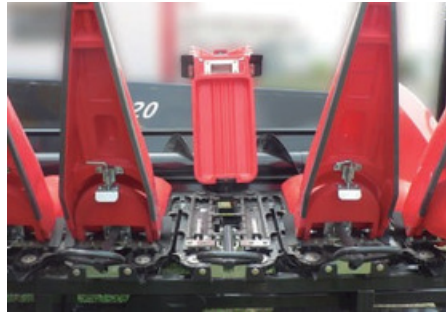
Sistema de anclaje de capota a resortes. Permite disminuir tiempos de trabajo de limpieza y mantenimiento de cadenas alzadoras. Transmisión de sinfín independiente de eje de mando de caja.
